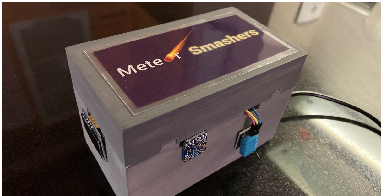
Ο μετεωρολογικός σταθμός με το προστατευτικό του κέλυφος.
