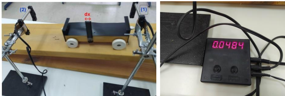
Εικόνα 3. Μέτρηση με το σύστημα φωτοπυλών
